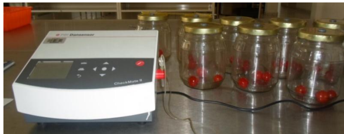
Figura 15. Analizador de gas de CO 2 /O 2 (PBI Dansensor analizador de gas, Checkmate II, Denmark)
