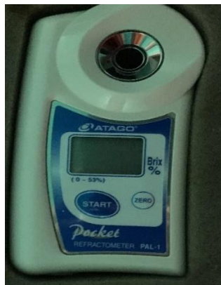
Figura 10. Equipo digital portátil empleado para la medición de Grados Brix.
