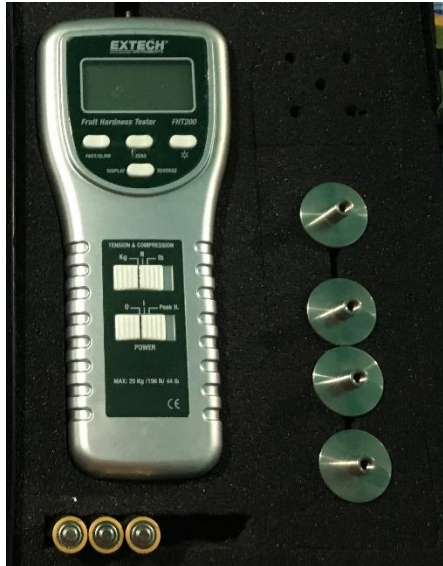
Figura 11. Equipo de medición portátil digital utilizado para determinar firmeza.
