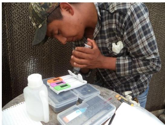
**Figura 10.** Colocación de savia en ionómetros para la medición de concentración de nutrientes
