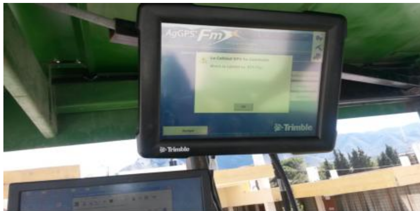
Figura 3.2 Pantalla FmX acoplada al tractor
