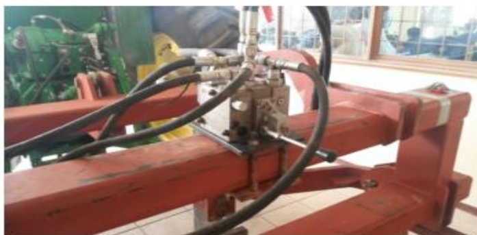
Figura 2.11 Válvula EP instalada en el implemento (Galindo, 2015).
