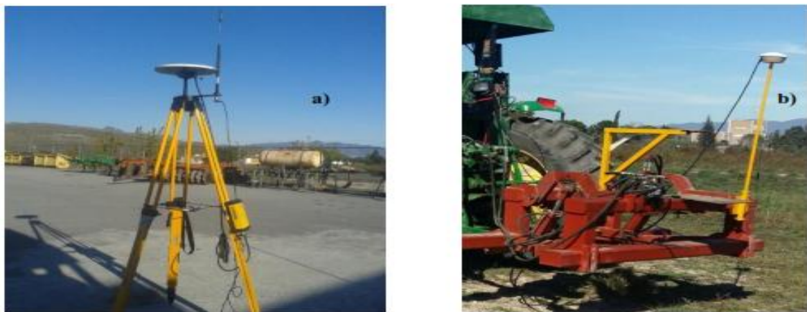
Figura 3.3 Sistema de corrección RTK, a) Estación base, b) Receptor móvil.
