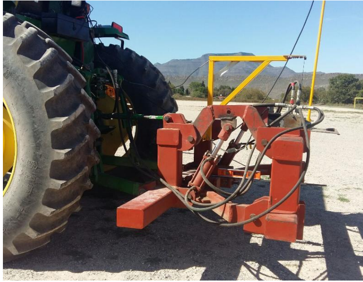
Figura 3.7 Actuadores en el punto neutro
