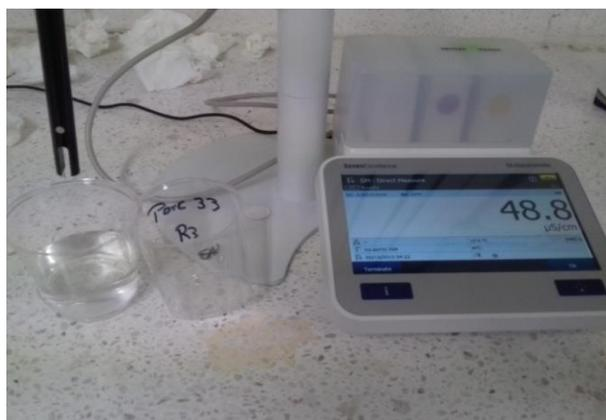
Figura 3.1 Calibración del Conductímetro Mettler Toledo
