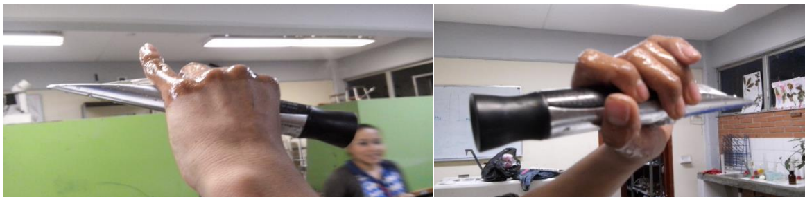
Figura 5. 5 Medición de los grados brix de la mezcla agua más mucilago
