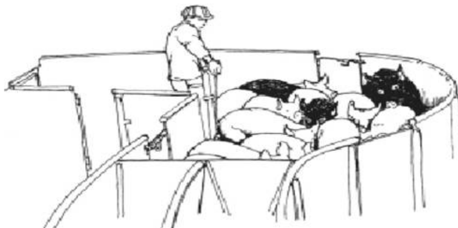
Corral redondo de abarrotamiento con una salida brusca para evitar que los cerdos se atasquen. Dibujo cortesía de www.grandin.com
