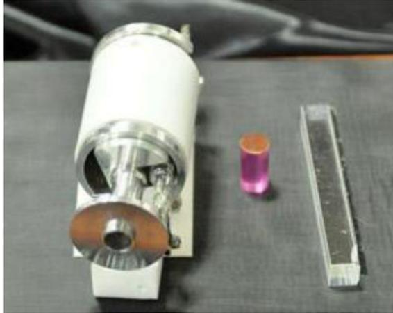
Figura 2. 6 Primer dispositivo láser inventado por Theodore Maiman.
