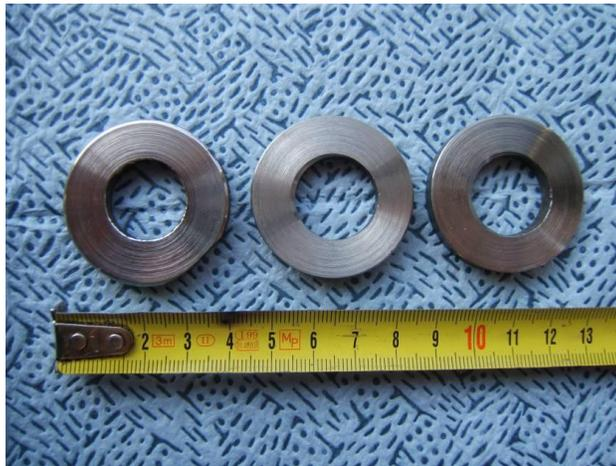
Figura 4. 1 Anillos o rodillos de Acero D2.
