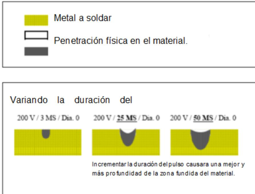
Figura 2. 16 Efecto de la duración del pulso en la soldadura láser.
