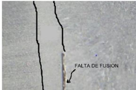
Figura 2. 12 Soldadura con falta de fusión en superficie.
