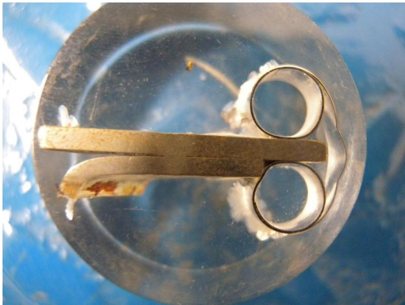
Figura 3. 10 Unión a traslape con pulsos de Nd-YAG.
