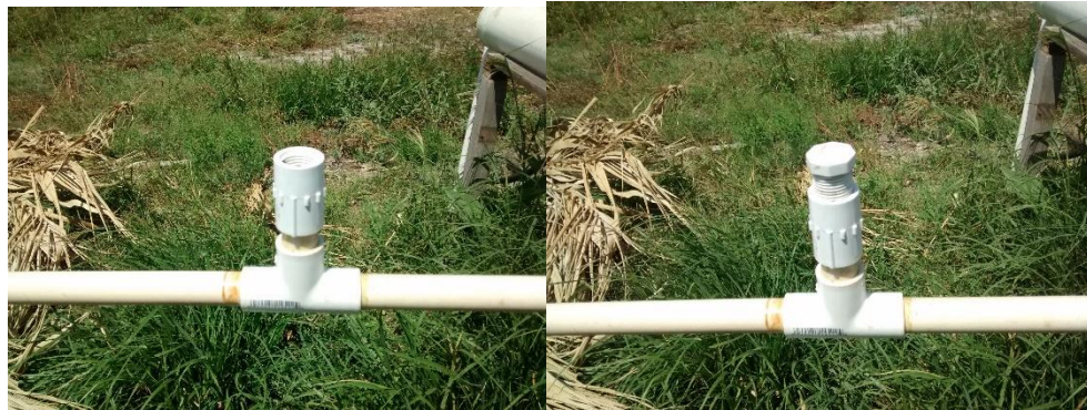
Figura 19. Válvula diseñada para la inyección rápida del trazador.
