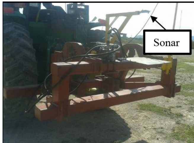
Figura 5. 10 Sensor de distancia acoplado al arado articulado
