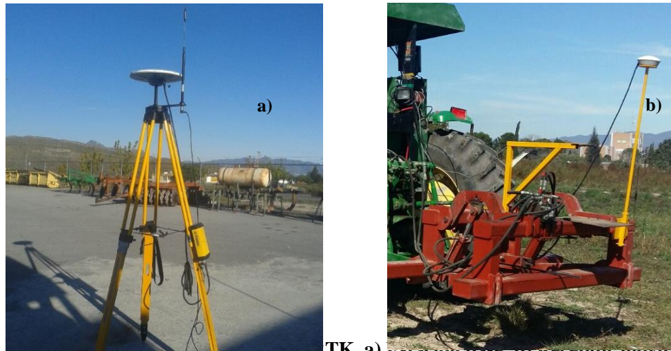
Figura 5.5 Sistema de corrección RTK. a) Estación base, b) receptor móvil
