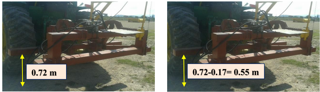
Figura 6. 8 Calibración del arado articulado
