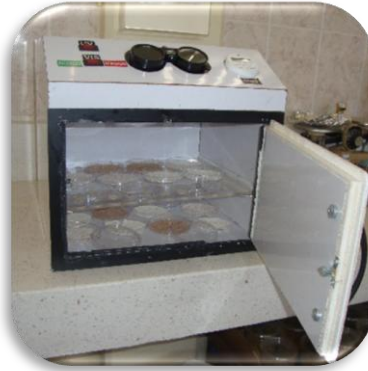
Figura 3.4. Cámara con luz ultravioleta para la esterilización de harina de maíz, harina de trigo y cascarilla.
