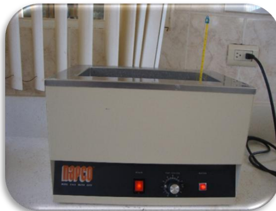
Figura 3.8. Baño María marca Napco utilizado para el análisis de proteína.
