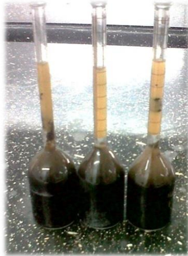
Figura 12. Determinación de grasa por Babcock
