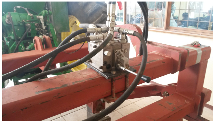
Figura 3.5: Válvula E.P instalada en el implemento
