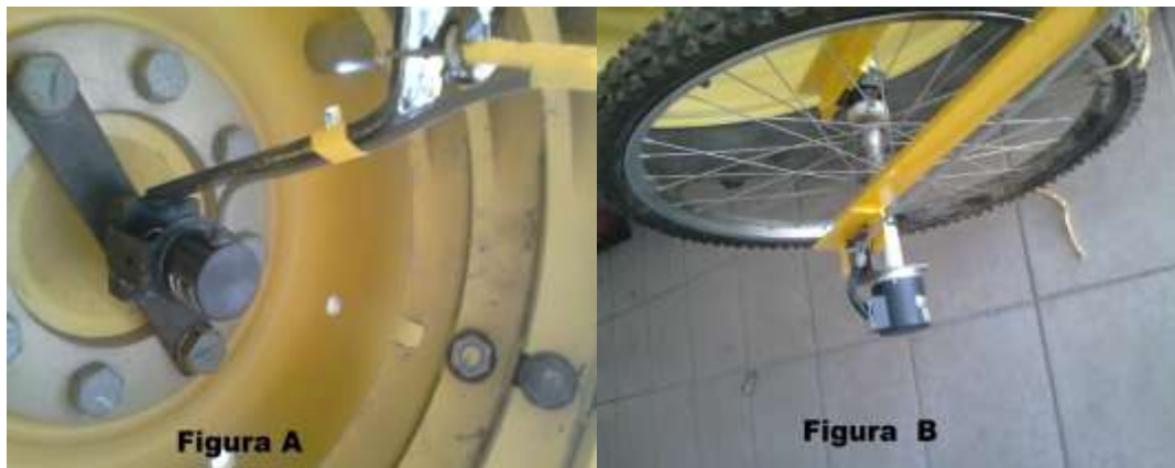
Figura 3.9 Ensamble de los encoder en la llanta motriz y en la llanta de la bicicleta
