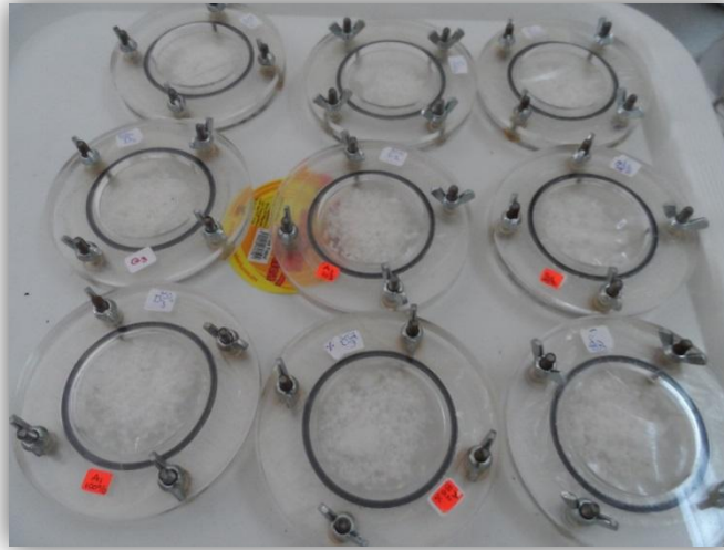
Figura 11. Determinación de permeabilidad
