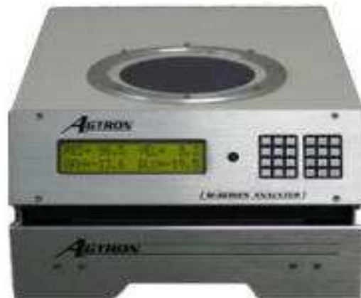
Figura 34. Equipo para determinar el color de las papas fritas.
