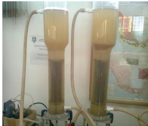
Figura 2: sistema secuencial anaerobio-aerobio.
