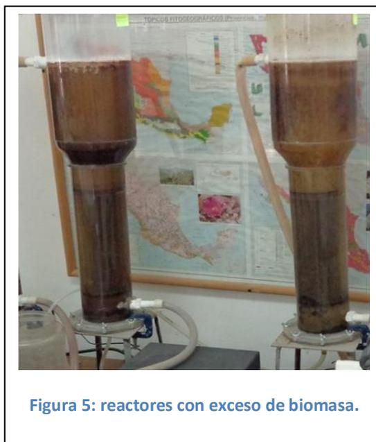
Figura 5: reactores con exceso de biomasa.
