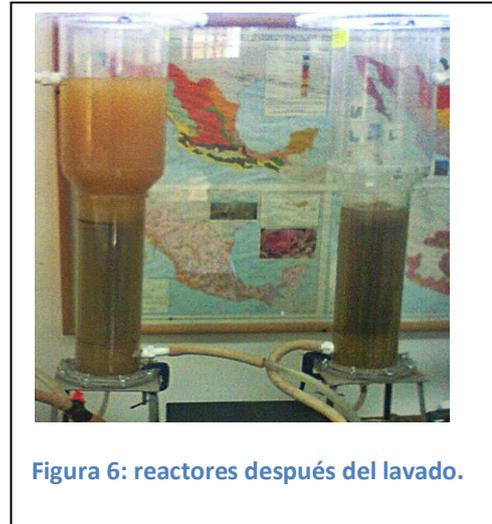
Figura 6: reactores después del lavado.
