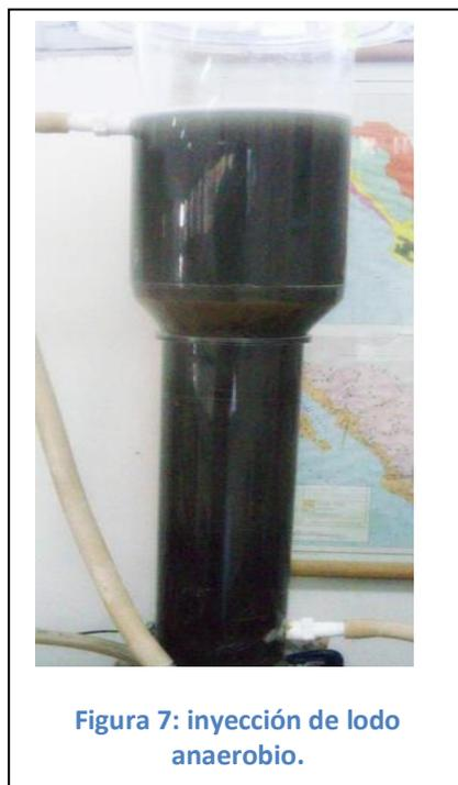
Figura 7: inyección de lodo anaerobio.
