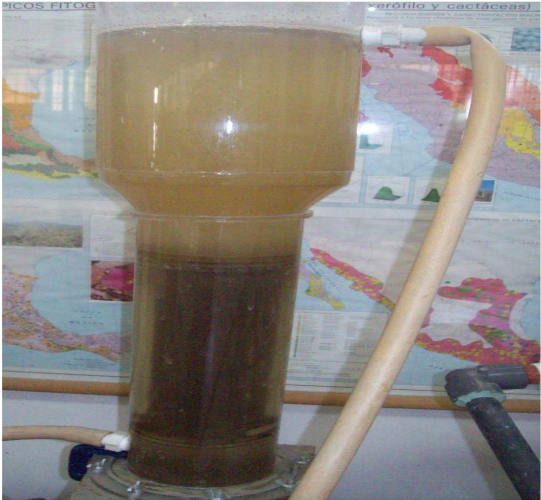
Figura 4. Después de la inoculación del reactor aerobio con lodos activados.
