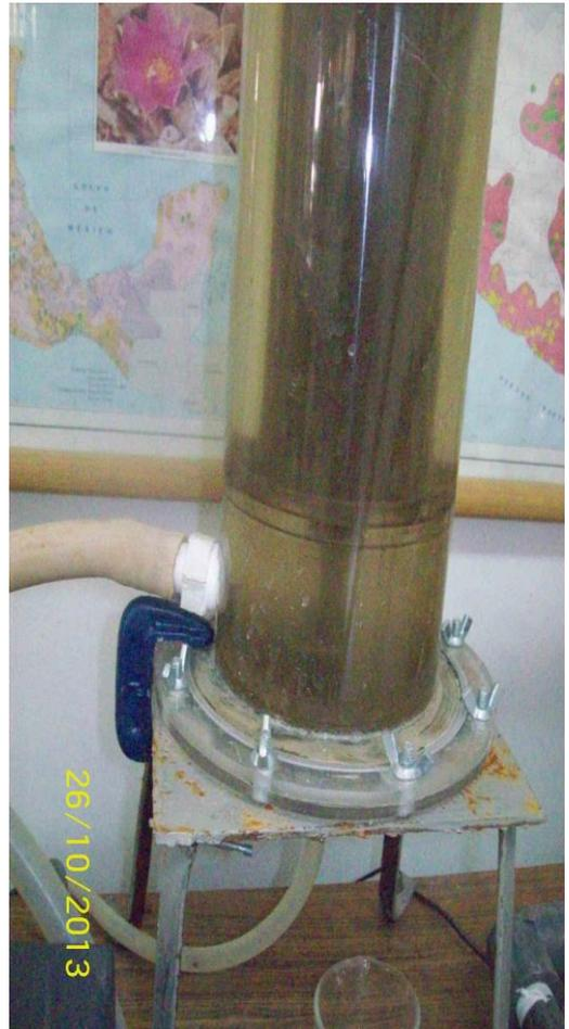
Figura 2. Reactor aerobio con acumulación de lodos, antes de su monitoreo.
