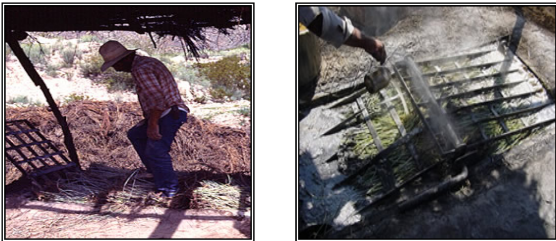
Figura 8. Pailas con agua y ácido sulfúrico donde se coloca la candelilla para extracción del cerote
