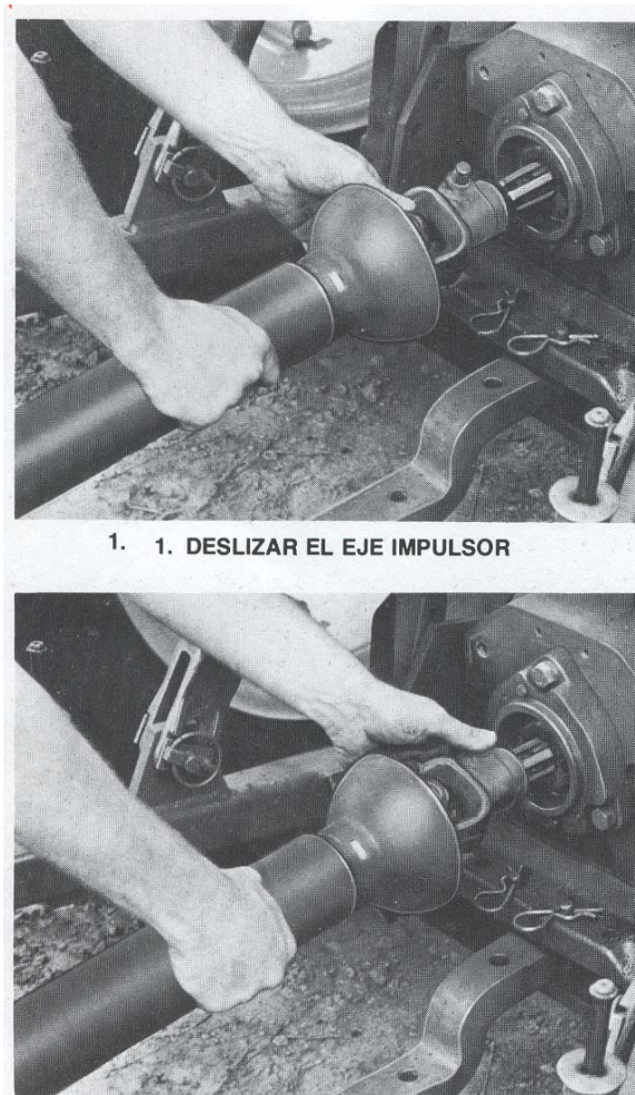
Figura 41. Acoplamiento a la toma de fuerza.
