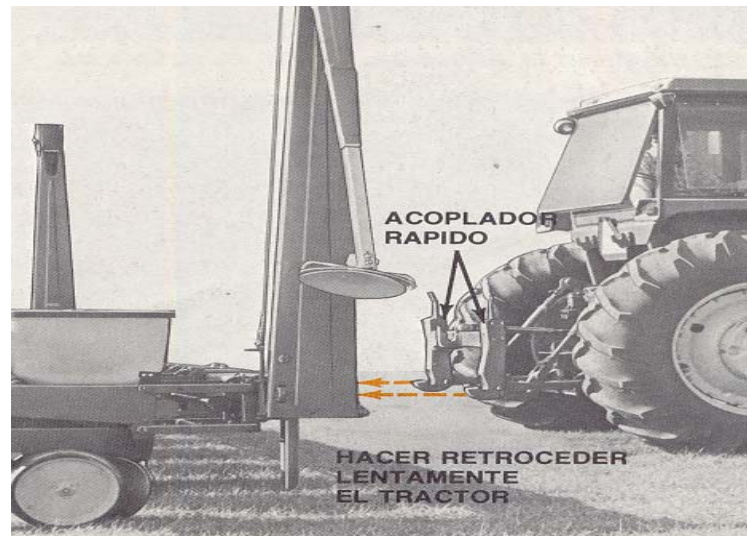
Figura 39. Bajar el enganche y retroceder lentamente.
