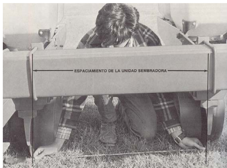
Figura 46. Ajustar el espacio entre hileras.
