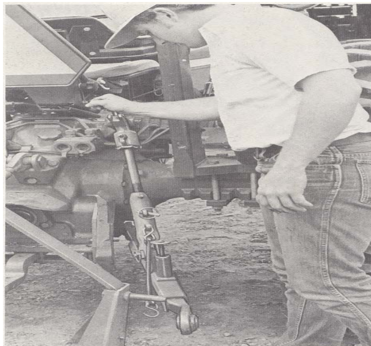
Figura 37. Ajustar la conexión elevadora derecha.
