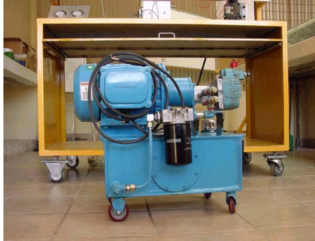
Figura 6.2 Unidad de potencia.
