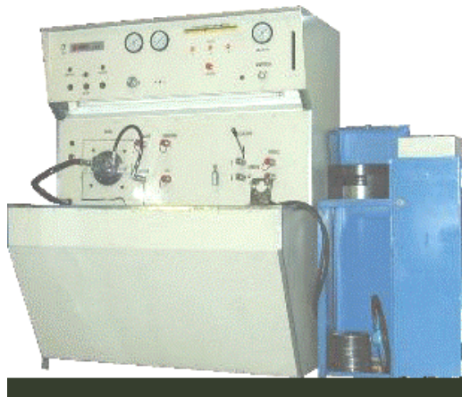
Figura 2.3 Banco fijo de pruebas hidráulicas (uso agrícola).
