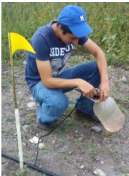
Figura 3.4. a). Aforando un microaspersor y b). Midiendo el caudal aforado.
