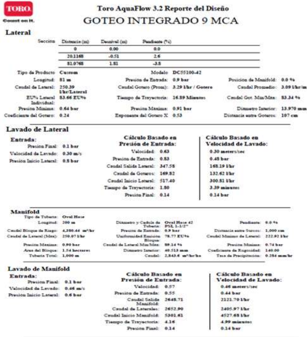
Figura 3.23. Ejemplo de un reporte de diseño de Aqua Flow 3.2.
