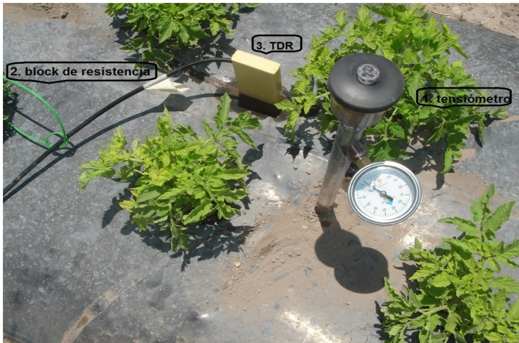
Figura 3. Estación de tres sensores instalados para determinar el contenido de humedad del suelo en un cultivo de tomate: 1. tensiómetro, 2. block de resistencia, 3. TDR
