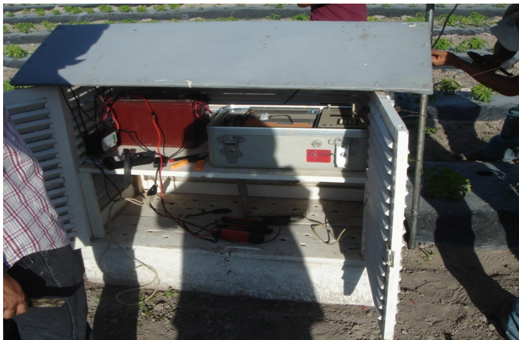
Figura 4 Datalogger (modelo CR7 Campbell Sci., Inc., Logan, Utah, USA) donde se conectaron los TDR para un registro continuo de la humedad del suelo.
