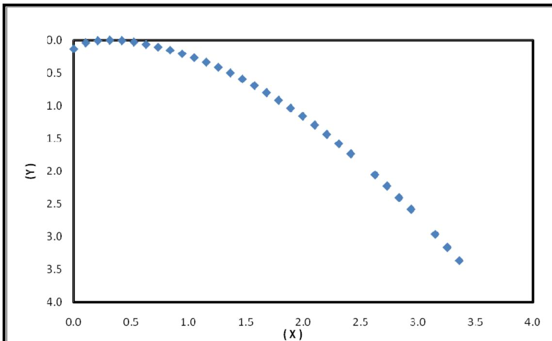
Figura 7. Perfil del vertedor tipo Creager.
