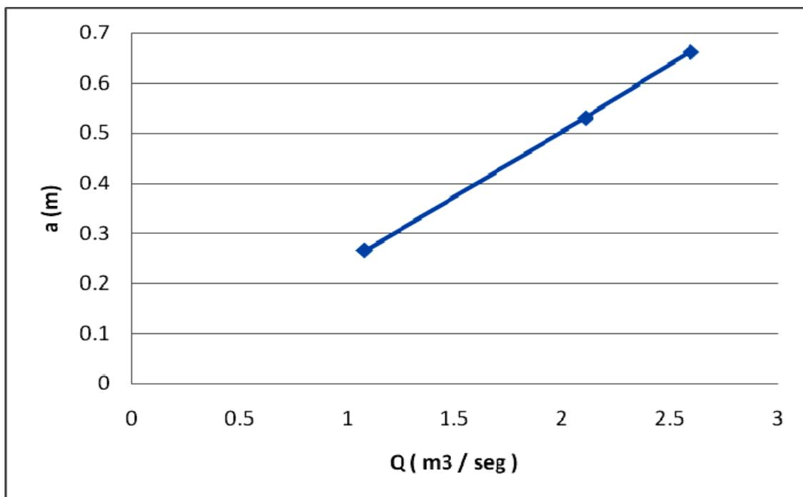
Figura 10. Gráfica del gasto en función de la abertura de la compuerta.
