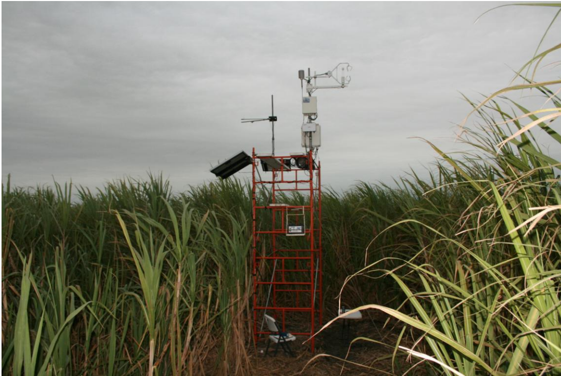
Figura 1. Torre y sensores para medir flujos de bióxido de carbono, calor latente, calor sensible, radiación neta y radiación fotosintéticamente activa sobre el dosel de un cultivo de caña de azúcar en Santa Anita, Xicoténcatl, Tamaulipas.
