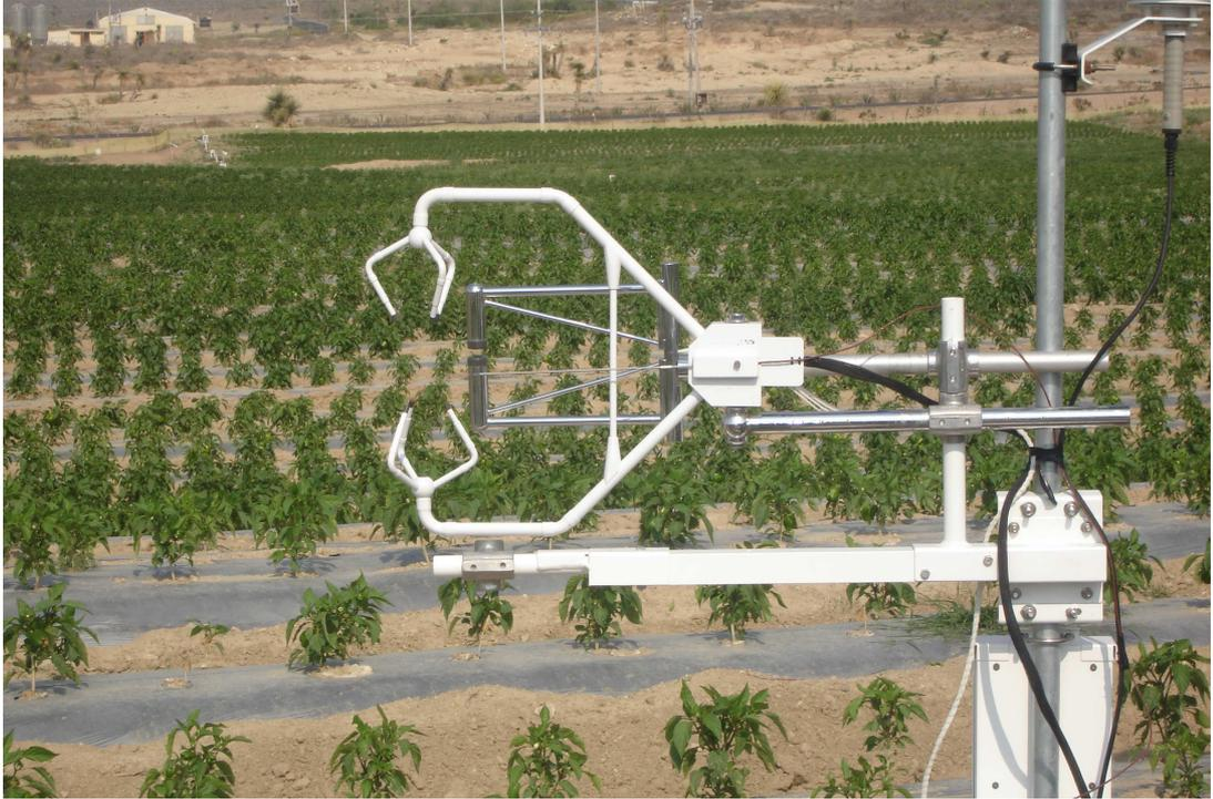
Figura 3.1. Sensores de un sistema eddy para mediciones de flujo de calor sensible (H) y latente ( $\lambda E$ ). 3-D anemómetro sónico, termopar de alambre fino, e hygrometro de kriptón de respuesta rápida.
