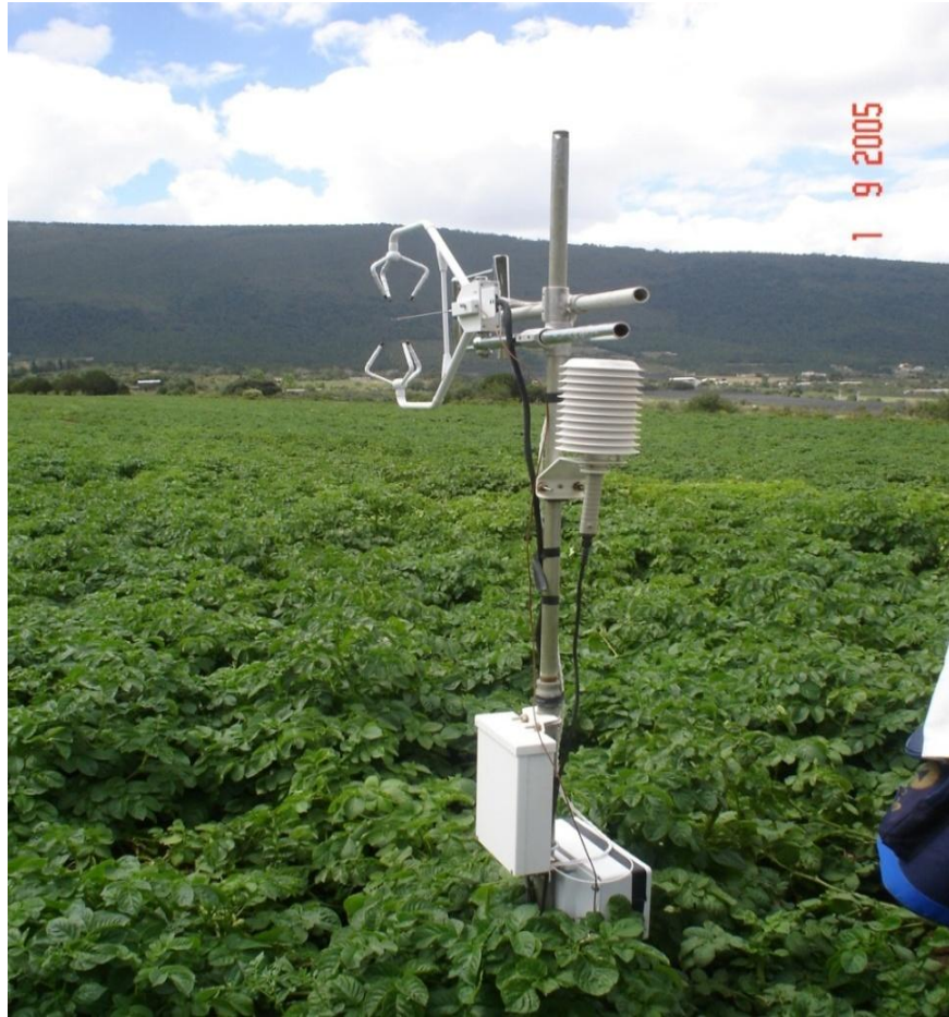
Figura 3. Sistema Eddy sobre un cultivo de Papa para mediciones de flujo de calor sensible (H) y calor latente (L).
