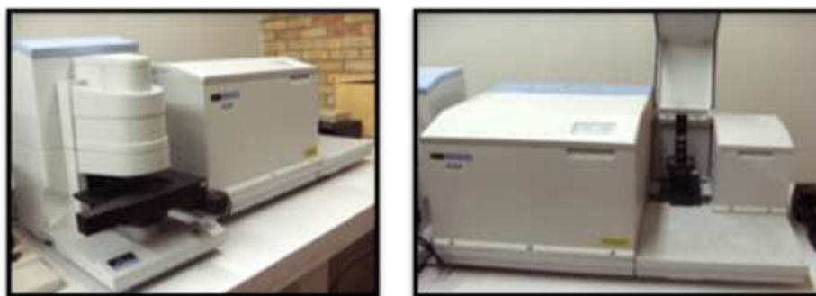
Figura 4. Espectrofotómetro de Infrarrojo, marca Perkin Elmer utilizando un dispositivo ATR con punta de diamante modelo GX00
