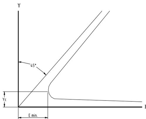
Figura 3.2. Curva de energía específica en canales.
