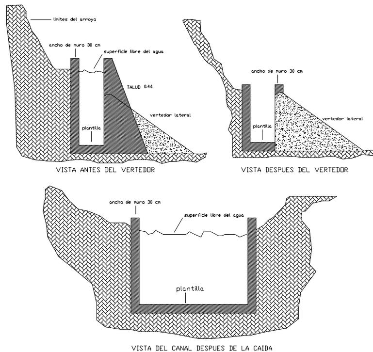
Figura 5.3. Características de las secciones del canal.
