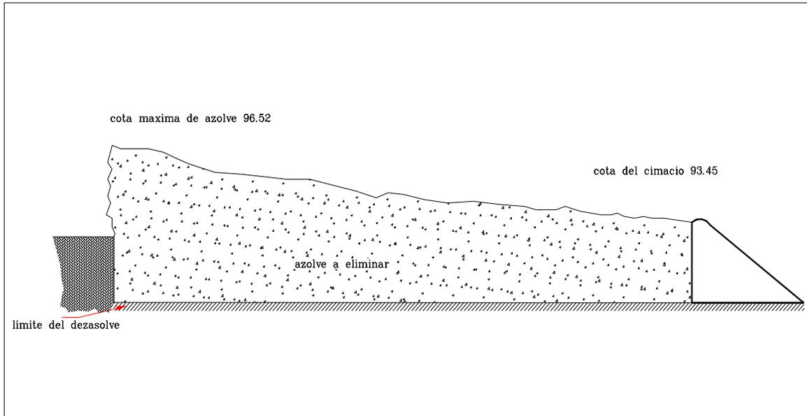
Figura 5.7. Perfil del área azolvada.
