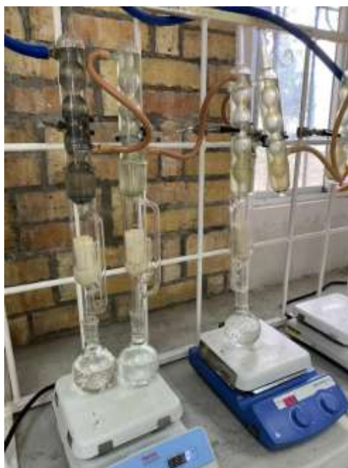
Figura 6. Sistema Soxhlet utilizado para la extracción de grasa. (Belmontes 2026).
