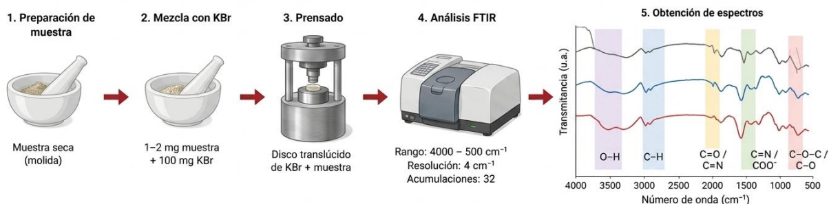
Figura 10. Procedimiento experimental de FTIR para los hidrogeles de CS/AlgOx y (MD-CS) /Alg
