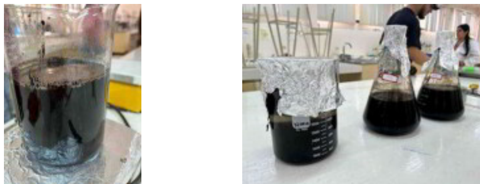
Figura 5: Síntesis nanopartículas de magnetita compuestas por biocarbón y biomasa de cáscara de nuez como fertilizante.
