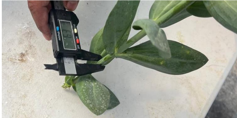
Figura 3. Registro de la medición de diámetro de tallos de lisianthus utilizando un vernier digital.
