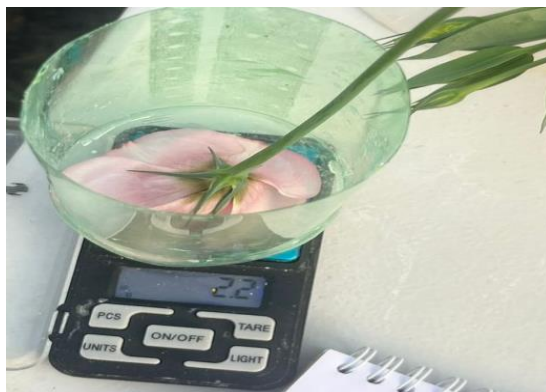
Figura 7. Registro de la medición de peso de la flor lisianthus utilizando una báscula digital.
