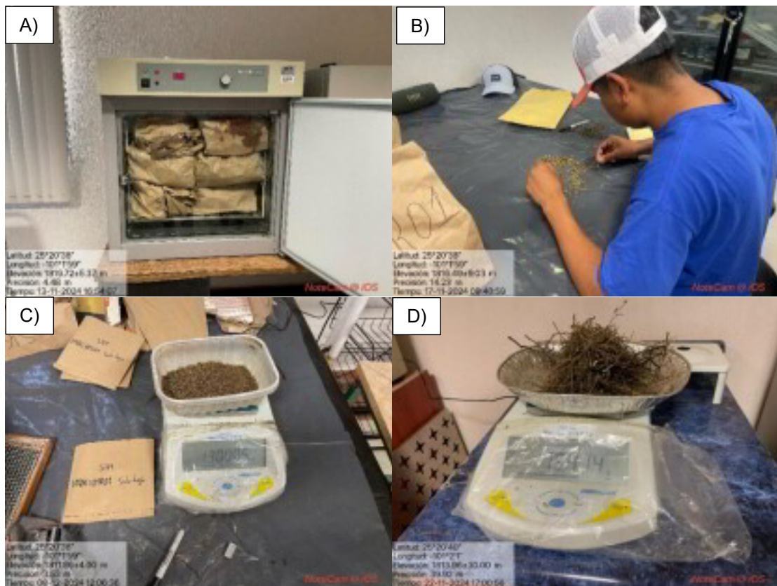
Figura 6. Obtención de biomasa seca de la planta gobernadora ( Larrea tridentata (DC.) Coville): A) Secado de muestras en estufa. B) separación de hojas y tallos. C) Peso de hoja seca. D) Peso seco de tallos. Fuente: Elaboración propia, 2025
