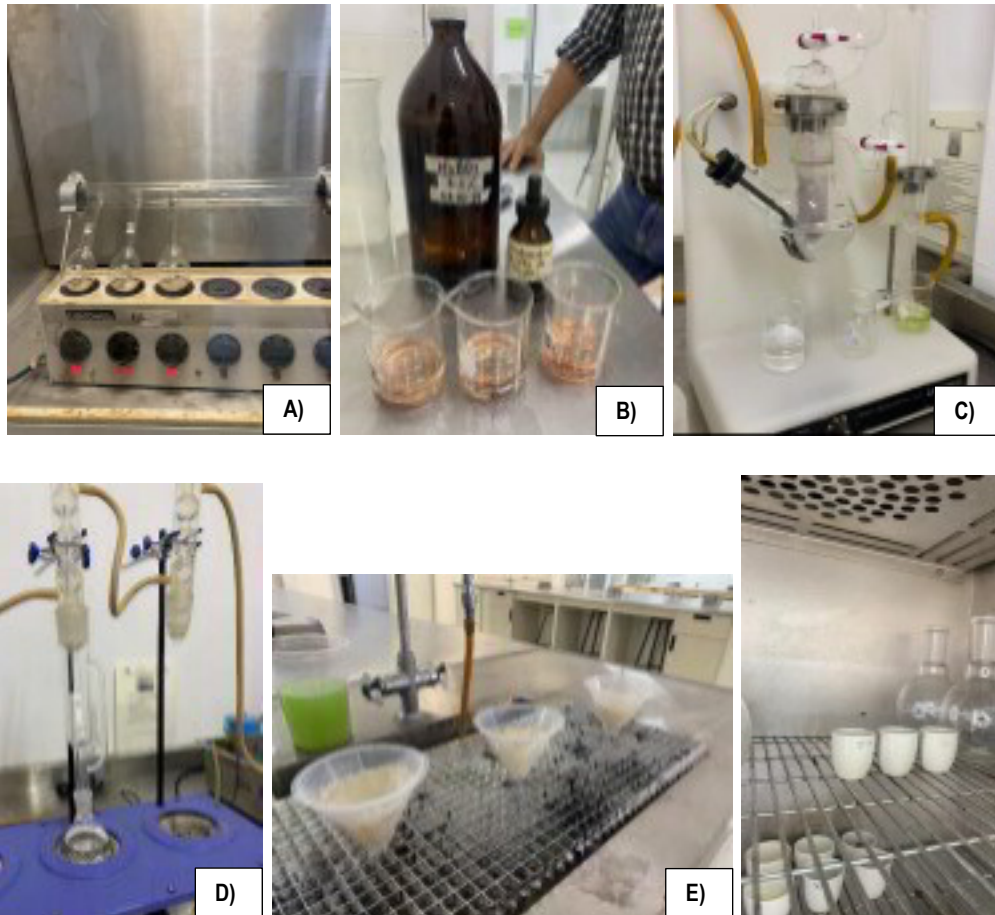
Figura 13. Determinación de grasa – fibra: a) muestras bajo campana de extracción de gases; b) muestra ácido sulfúrico; c) muestras desengrasadas; d) extracción Soxhlet; e) obtención de fibra y f) muestras bajo estufa a 150°C.
