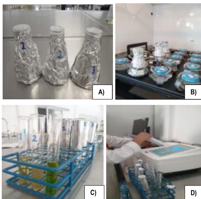
Figura 7. Fenoles totales: a) muestra de moringa (hidroetanólico, etanólico y acuosa); b) muestras en agitador Shaker; c) dilución de las muestras; d) absorbancias bajo espectrofotómetro.
