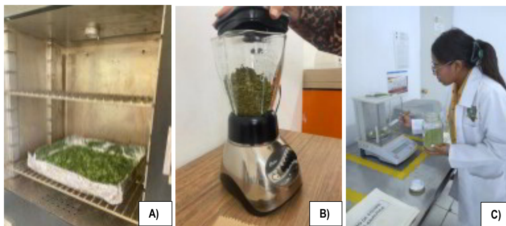
Figura 6. Preparación de la materia prima: a) secado de muestra; b) obtención del polvo de la muestra; c) peso de la moringa en polvo para muestra.
