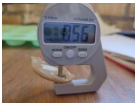
Figura 2 Medición de recubrimientos
