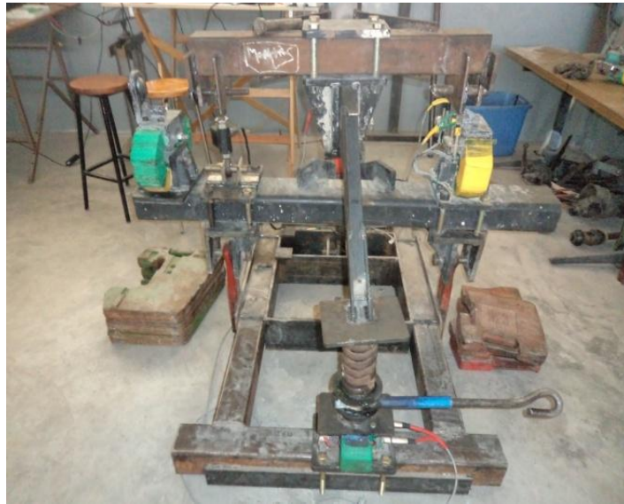
Figura 4.7.1. Prueba con el sensor integral montado en el banco de pruebas.
