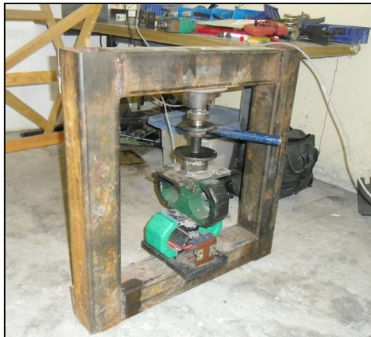
Figura 4.2.1. Marco de calibración de los sensores individuales con capacidad de 10 kN.
