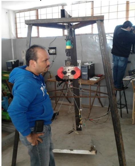
Figura 4.3.3. Plataforma de calibración en una forma en serie de los sensores individuales.
