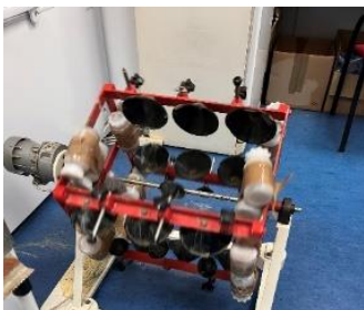
Fig. 20 y 21: Extracción muestras de suelo en el laboratorio de la UPCT, España, noviembre, 2023.
