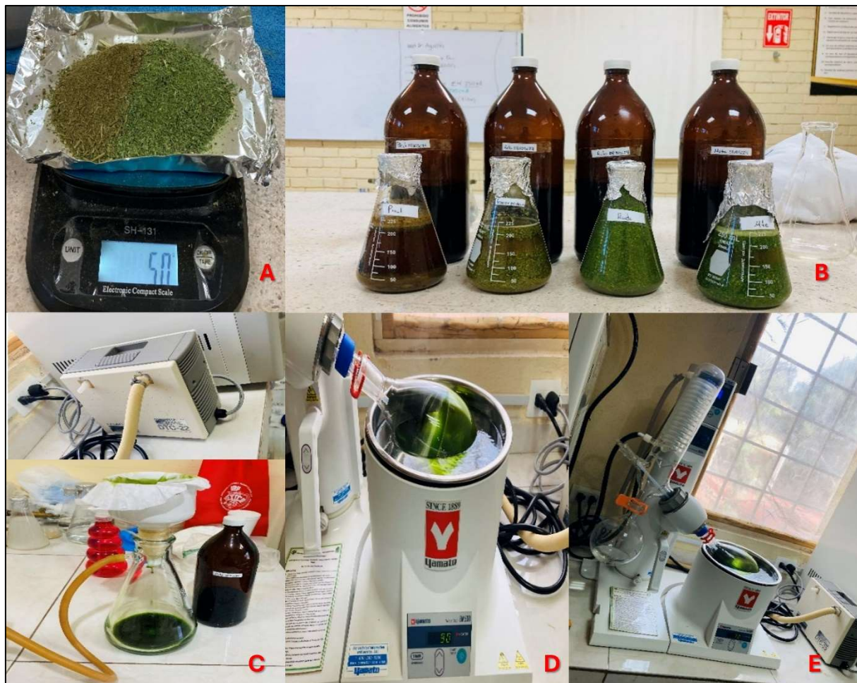
Figura 5. Obtención de extractos etanólicos. A: Pesado del material vegetal. B: Almacenamiento en frascos ámbar. C: Filtración, mediante papel filtro y mediante bomba de vacío tipo seco (modelo DTC-22 ULVAC). D y E: Proceso de rotavaporación.
