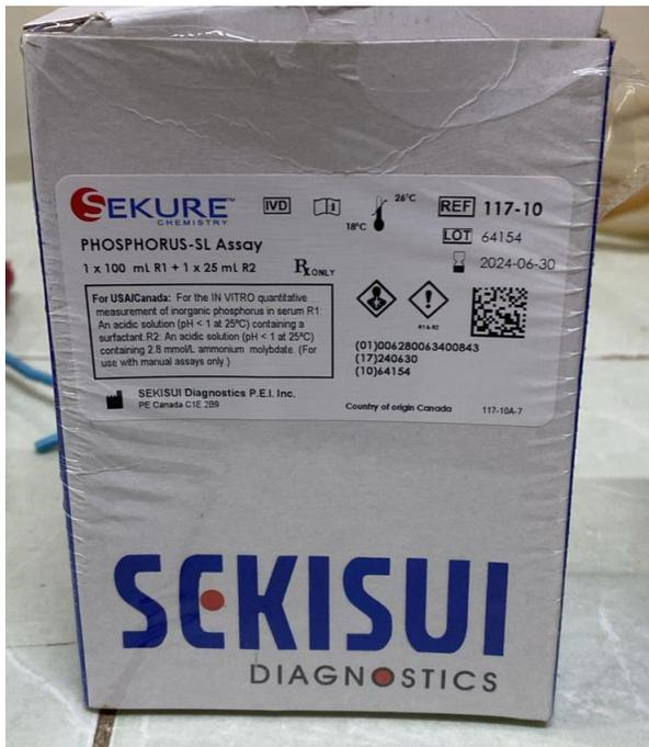
**Figura 3** Kit para analizar Fósforo empleado para la química sanguínea
