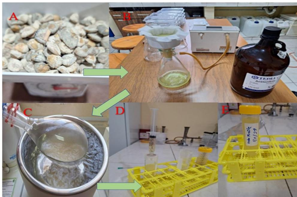
Figura 7. Elaboración de extractos. A: Peso de semillas para procesar. B: Filtración de extracto en bomba de vacío. C: Rota-evaporación del extracto. D: Filtración de extractos para su esterilización. E: Almacenamiento de extractos para su utilización
