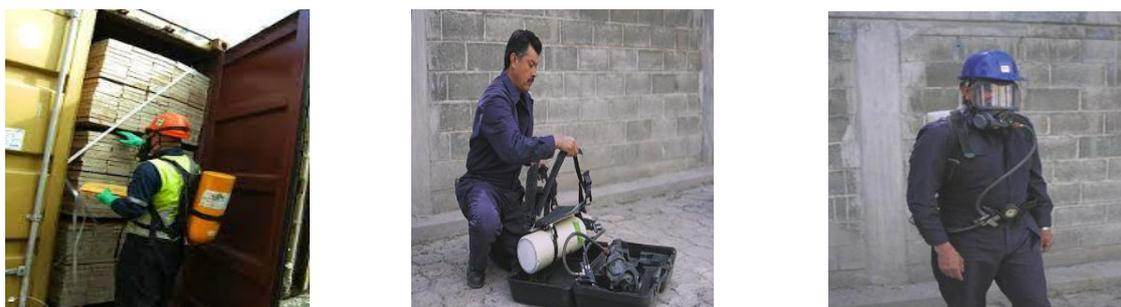
Figura 37: Equipo de respiración autónomo
