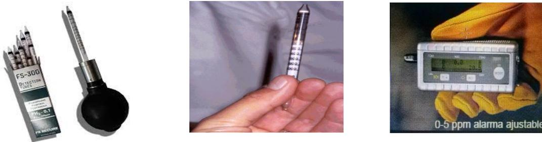
Figura 35: Equipo de medición de fosfina
