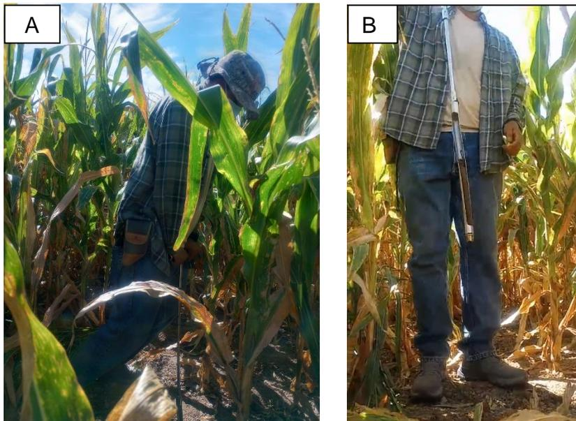
Figura 5. Muestreo de humedad con barrena tipo T de 61 cm de longitud, con un tubo de muestreo de 30 cm.
