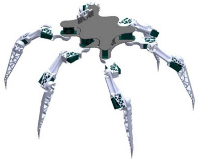
**Figura 1.** Simulación de diseño mecánico de prototipo hexápodo en SolidWorks.
