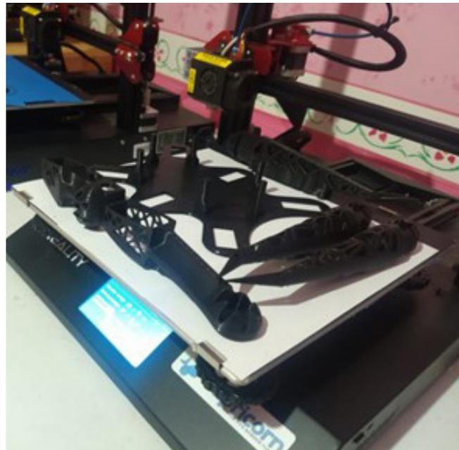
Figura 3. Proceso de manufactura por impresión 3D con material PLA.
