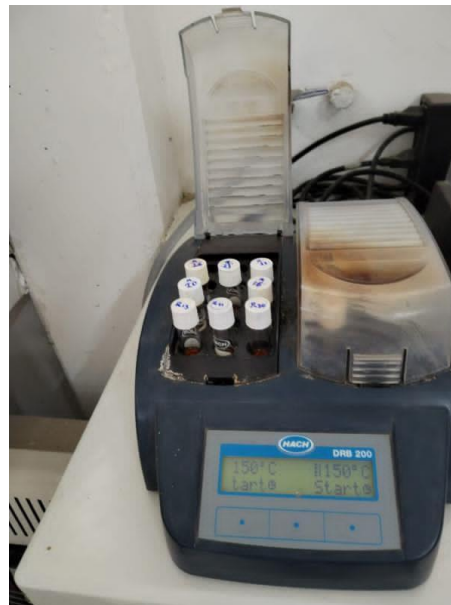
Figura 4. Digestión de los tubos a 150°C por 2 horas.
