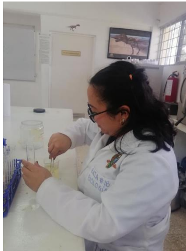
Figura 9. Llenado y colocación de las campanas de Durham.
