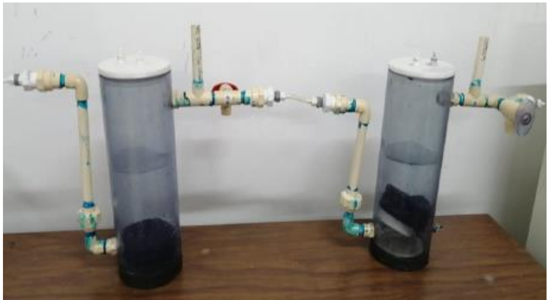
Figura 1. Sistema bioelectroquímico de dos cámaras utilizado en la investigación.
