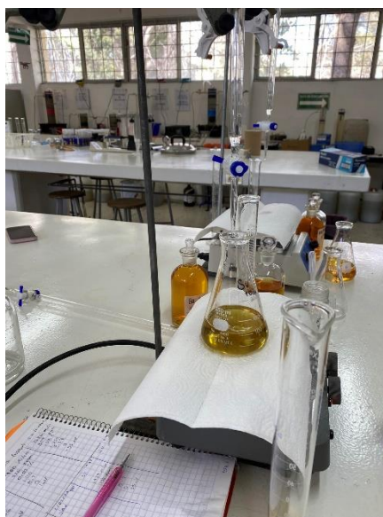
Figura 5. Aclaración de la muestra con tiosulfato de sodio.
