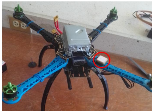
Figura 3.28 Modulo GPS UBX M10050 instalado en el chasis.
