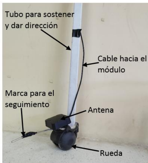
Figura 4.12 Acondicionamiento de la antena del rover para las pruebas de precisión.
