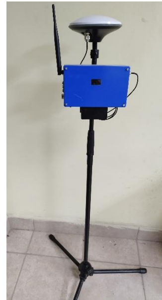
Figura 3.35 Estación base RTK.
