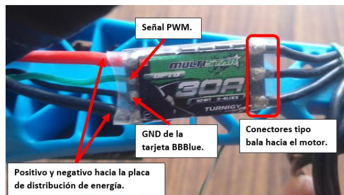
Figura 3.22 Descripción de las conexiones en los ESC's.
