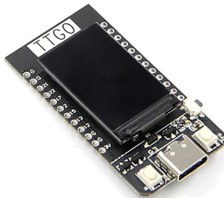
Figura 3.18 módulo de desarrollo TTGO ESP32 con display 1.14P, USB TIPO C, WIFI 4MB. (Starware, 2023).
