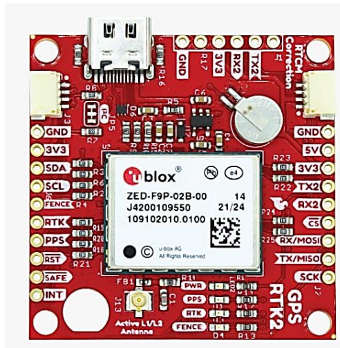
Figura 3.10 GPS-RTK2 con el módulo ZED-F9P-02B-00. (SparkFun Electronics, 2023).
