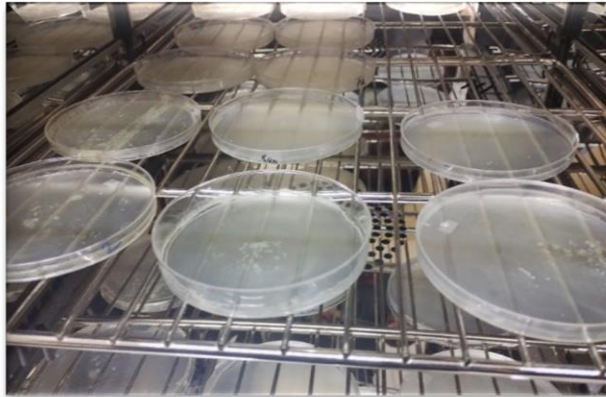
Figura 6. Secado de las películas de goma xantana y quitosano.
