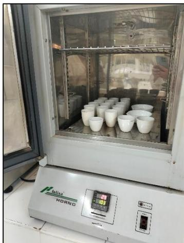
**Figura 6.** Cápsulas y crisoles de porcelana dentro del horno.
