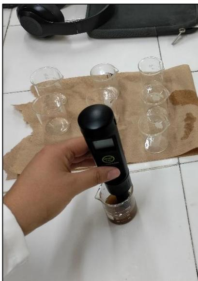
**Figura 4.** Potenciómetro sumergido en una muestra de biol.
