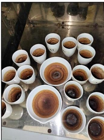
**Figura 6.** Muestras evaporadas en el horno de secado.
