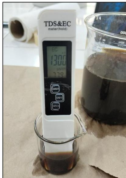
**Figura 5.** Conductímetro sumergido en una muestra de biol.
