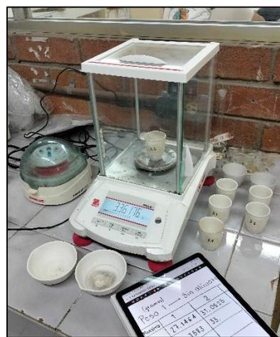
**Figura 8.** Proceso de pesado de cápsulas y crisoles en la balanza analítica.
