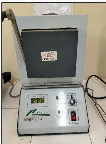
**Figura 4.** Mufla a 600 ° C para la introducción de muestras.
