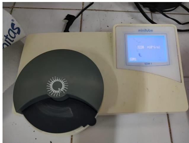
**Figura 8. Fotómetro utilizado en el CIPA-UL, para medir concentración espermática.**
