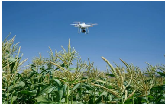
Figura 2.6 Dron multirrotor, de tipo Quadcopter, utilizado para la captura de imágenes RGB. Fuente: (DJI, 2023)
