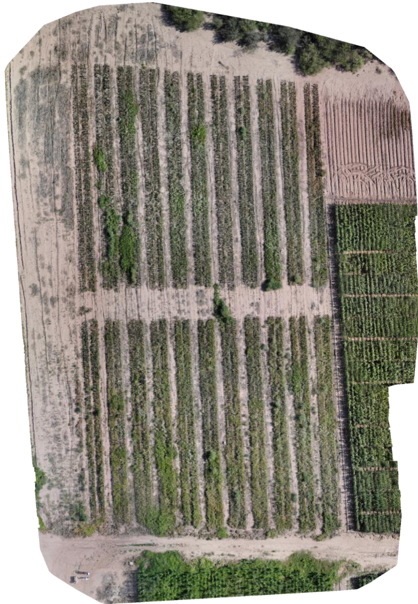
Figura 5.3 Ortomosaico obtenido al realizar el análisis en el software PIX4D con las capturas recabadas durante el vuelo. Fuente: (González, 2023).
